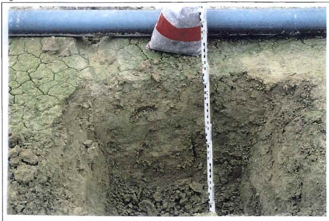
Figura 7.76.- Toma de muestras del lecho de las balsas filtrantes.
